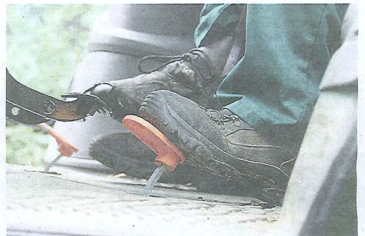
Weil Herbert Dänzer das rechte Bein zum Gasgeben nicht mehr benutzen kann, wurde nachträglich ein zusätzliches Fahrpedal eingebaut.
