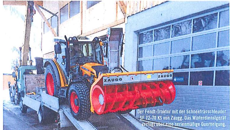
Der Fendt-Traktor mit der Schneefrässhleuder SF 72-70 KS von Zaugg. Das Winterdienstgerät verfügt über eine serienmäßige Querneigung.
